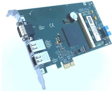
Zwischenzeitlich ist die MCU-3100e-EC verfügbar. Dies ist eine reine EtherCAT Variante der MCU-3100 realisiert als PCI-Express-Karte.
